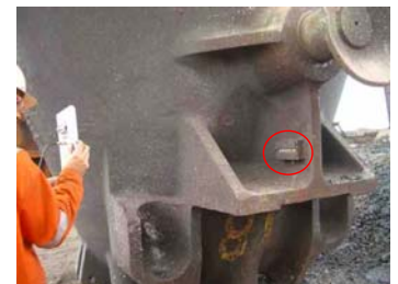
SAW-Transponder im Einsatz am Behälter
